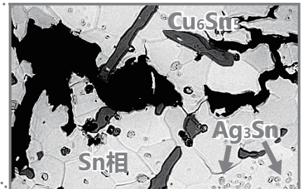
冷热循环后组织粗大化
